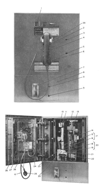
Fig. 2---♦2D-Type Coin Telephone Set€
