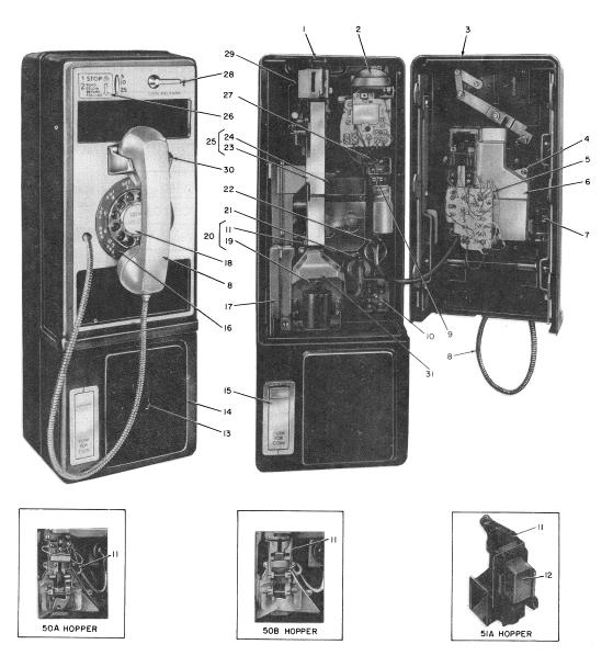
Fig. 1—1-Type Coin Telephone Set
