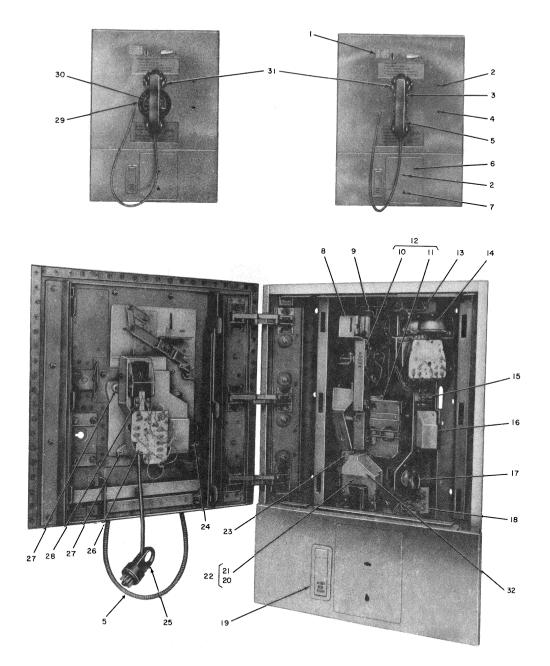
Fig. 2—2-Type Coin Telephone Set
