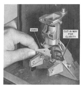
Fig. 3—Inserting Vane
